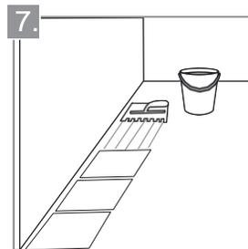
Esparra mortero de pega sobre un área equivalente a dos piezas y cree surcos con la llana dentada. En formatos superiores a los 33 x 33 cms., repita el procedimiento en la cara oculta de la pieza.
