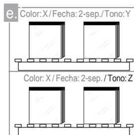
Agrupe las cajas de acuerdo a su tono, lote y fecha de fabricación. Compare visualmente las piezas para verificar la uniformidad de su superficie. Este proceso debe realizarse en exteriores y a la luz solar. Si instala referencias rústicas o con variación tonal alta V4, combínelas para establecer homogeneidad en las vetas o los diseños.
