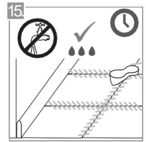
Retire los excesos de boquilla con una esponja humedecida en agua limpia antes de que se cumplan 15 minutos de su aplicación. No omita este paso, pues el contacto prolongado con el material de rejuntado ocasiona daños irreparables en la superficie de las piezas.
