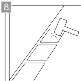
Adhiera cada pieza presionando levemente hacia abajo girándola un poco hacia los lados. Golpee con el martillo de goma para evacuar restos de aire presentes en el material de pega.
