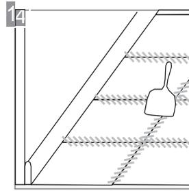
Aplique el material de boquilla perimetralmente y de manera tal que tenga un grosor equivalente al 90% de la altura de las piezas. No emboquille a tope para prevenir el desprendimiento del material. Las piezas tipo precorte deben emboquillarse completamente. Utilice una espátula de goma para prevenir el rallado.
