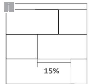
Realice la instalación de manera tal que la línea entre las piezas forme una cuadrícula. Si desea colocar los productos en un patrón escalonado o de 'junta trabada', hágalo de manera tal que la intersección entre las fichas no supere el 15% del lado total de la pieza.
