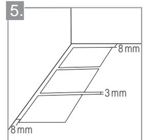
Utilizando únicamente crucetas plásticas, mantenga una distancia de 3 mm. entre las piezas. Esta separación compensa las diferencias dimensionales entre las baldosas y previene su levantamiento. La dilatación puede ser mayor si se instala en exteriores o piezas con formatos superiores a los 30 x 90 cm, pero nunca debe superar los 6 mm. de ancho para prevenirla fractura de la boquilla.
